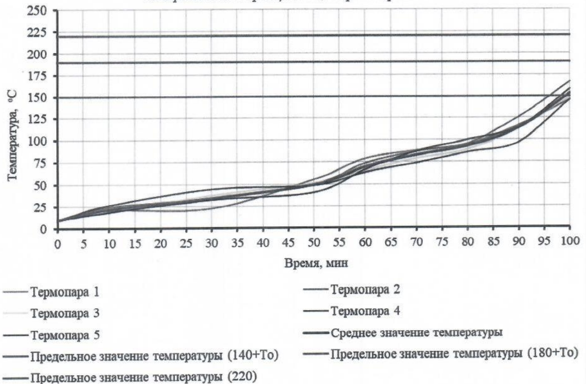
Рисунок 4. График локальных значений и среднего значения температуры на необогреваемой поверхности Образца № 2, термопары 1-5
